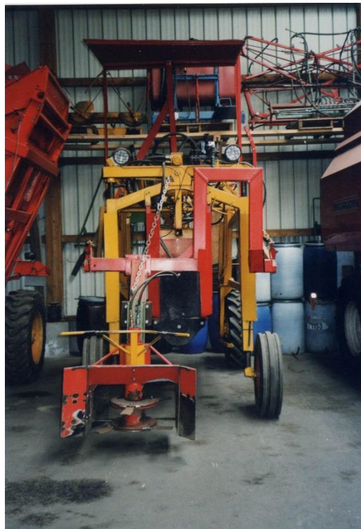
Abb. 16: Stelzengerät mit höhenverstellbarer Mähvorrichtung; letztere kann einerseits zum Entfahnen verwendet werden, als auch nach dem Abblühen (Bestäuben) der Vaterlinien zum Abmähen dieser; die Vaterlinien werden in der Hybridsaatgut nicht geerntet; die Erhaltung der Vater-Inzuchtlinien erfolgt gesondert in einem eigenen Zuchtgarten.
